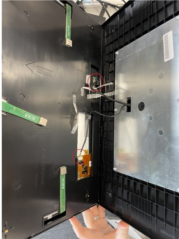
主显示屏内部连接情况示意图
