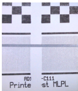
打印断码，需更换热敏打印头
