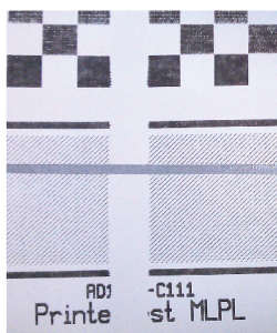
打印断码, 需更换热敏打印头
